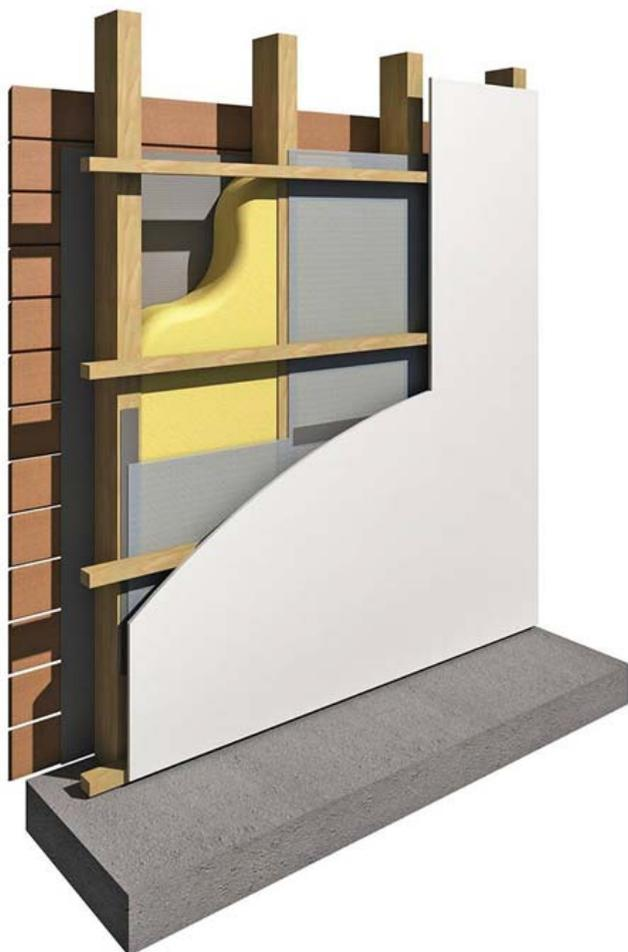
Figure 11 : Système constructif entre montants en bois
