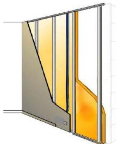
Figure 8 : Contre-cloison constituée de montants simples ou doubles sans fixation intermédiaire au support
