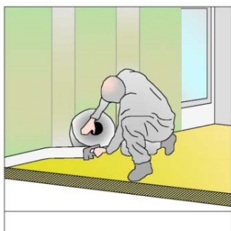
Figure 11 : Réalisation de la désolidarisation périphérique
